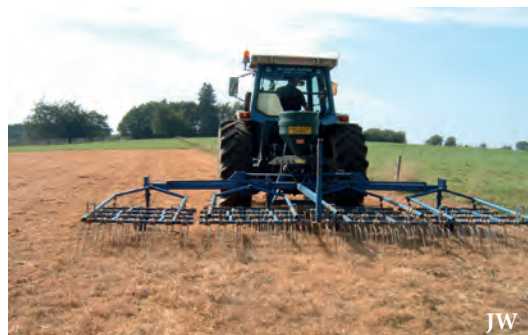
Semis direct à l'aide d'une herse étrille
