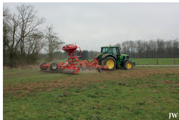
Réparation de dégâts superficiels à l'aide d'un combiné herse/rouleau/semoir
