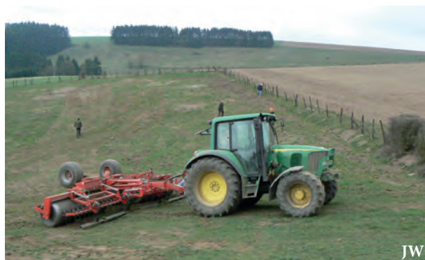
Herse étrille équipée d'une barre niveleuse et de gros rouleaux
