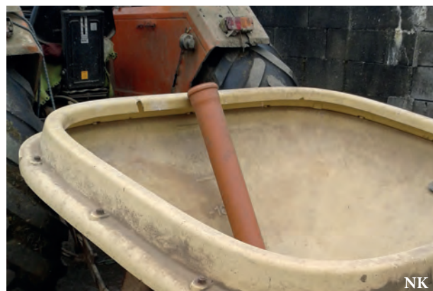
Système « maison » : tube en PVC permettant d'isoler les semences de l'engrais
