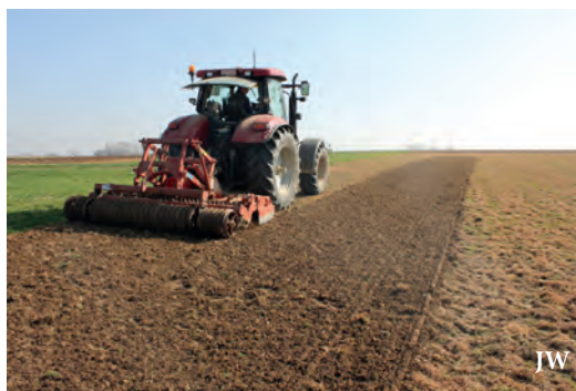
Préparation du lit de germination à la herse rotative
