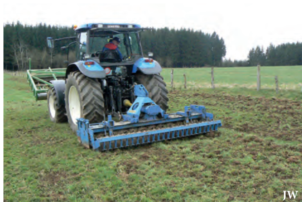
Herse rotative réglée de manière superficielle
