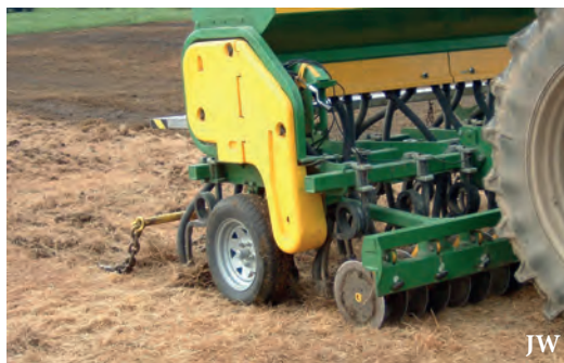
Les disques du semoir spécifique creusent des sillons dans le sol
