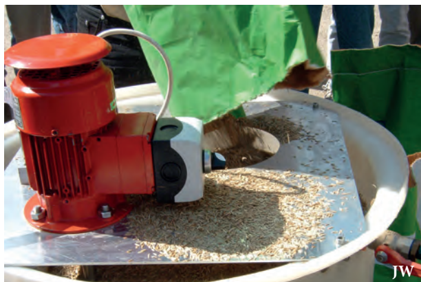
Système du tonneau à lisier : mélange des semences de graminées dans une cuve contenant de l'eau
