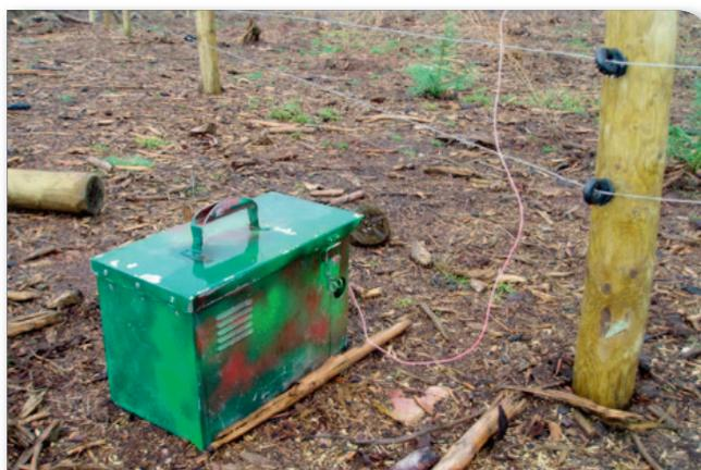
Pour éviter le vol du matériel, il vaut mieux placer l'électrificateur sous boîtier protégé, lui-même attaché par une chaîne à un piquet.
