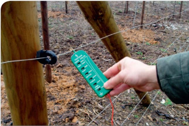
Un voltmètre permet de s'assurer que la tension électrique dans le fil est suffisante.
