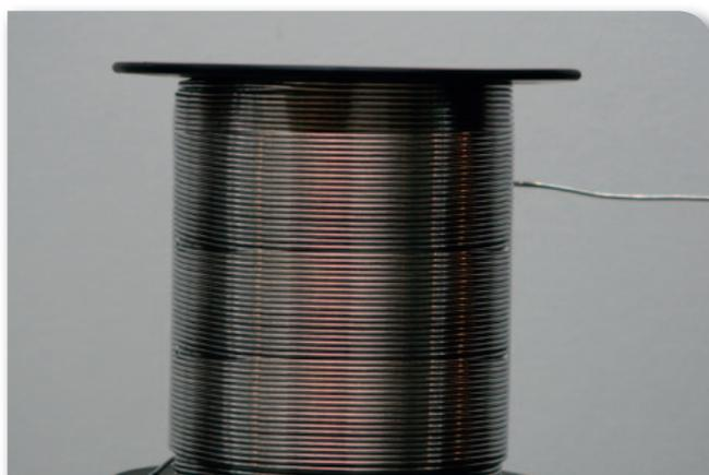
Le fil en aluminium est plus souple et plus conducteur que le fil en acier galvanisé.
