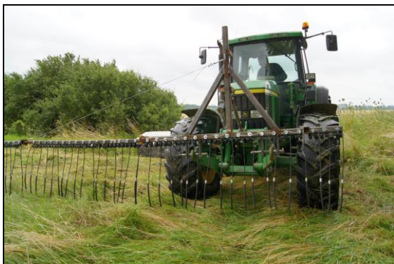
Barre d'effarouchement (© J. Chauvigne)
