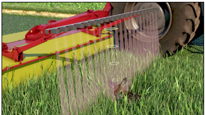
Détection par capteurs optiques à infrarouge (© Pöttinger)
