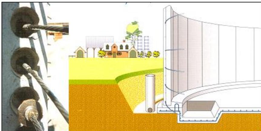
Figure A12 : parois en éléments préfabriqués pour fosse
