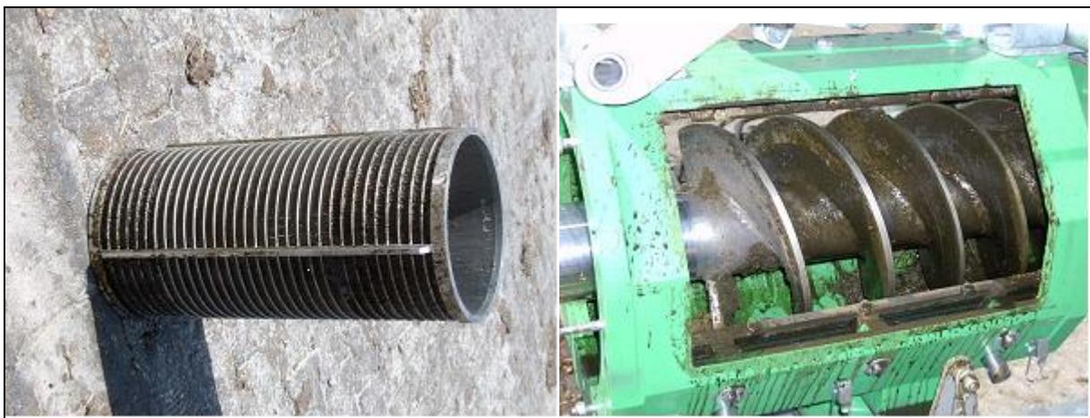
Tamis filtrant de 0,5 mm entourant la vis sans fin. Vue du corps du séparateur + vis sans fin.
