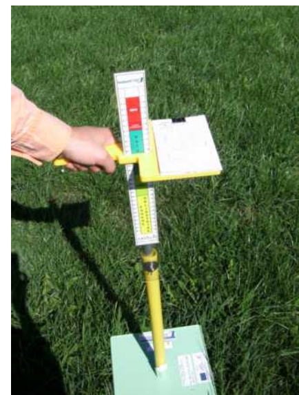
L'herbomètre mesure la hauteur de l'herbe, en tenant compte de sa densité.
