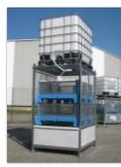
➤ **Fonctionnement :** Evaporation des effluents contenus dans une sachette Osmofilm® (capacité de 250 l) uniquement perméable à la vapeur d'eau disposée dans un casier.
